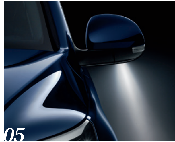
Ytterbackspeglar, elektriskt infällbara med markbelysning
