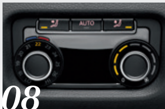
Manöverpanel bak för klimatanläggningen
