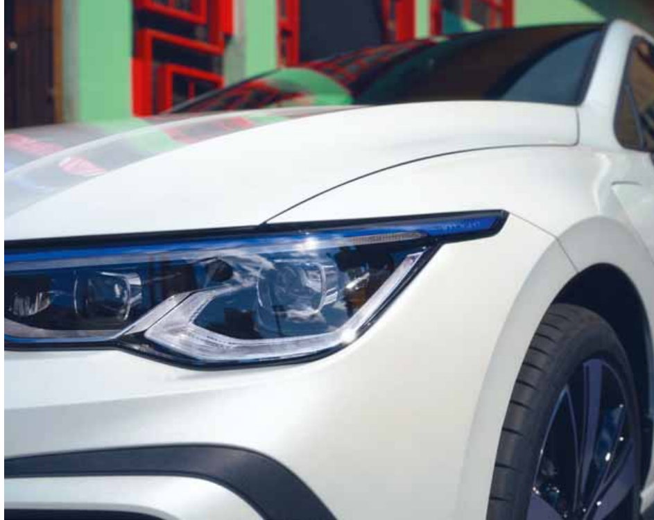
LED-Matrix strålkastare med dynamisk ljusassistent och ladduttag i vänster framskärm.
