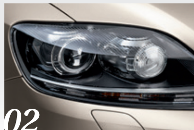
Bi-xenonstrålkastare med dynamiskt kurvlyjus
